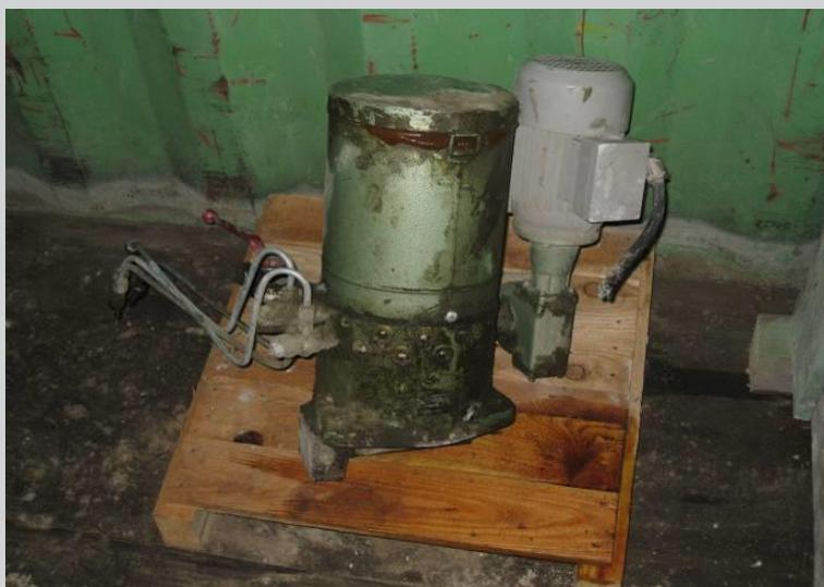
Pumpe für Zahnkranzschmierung
