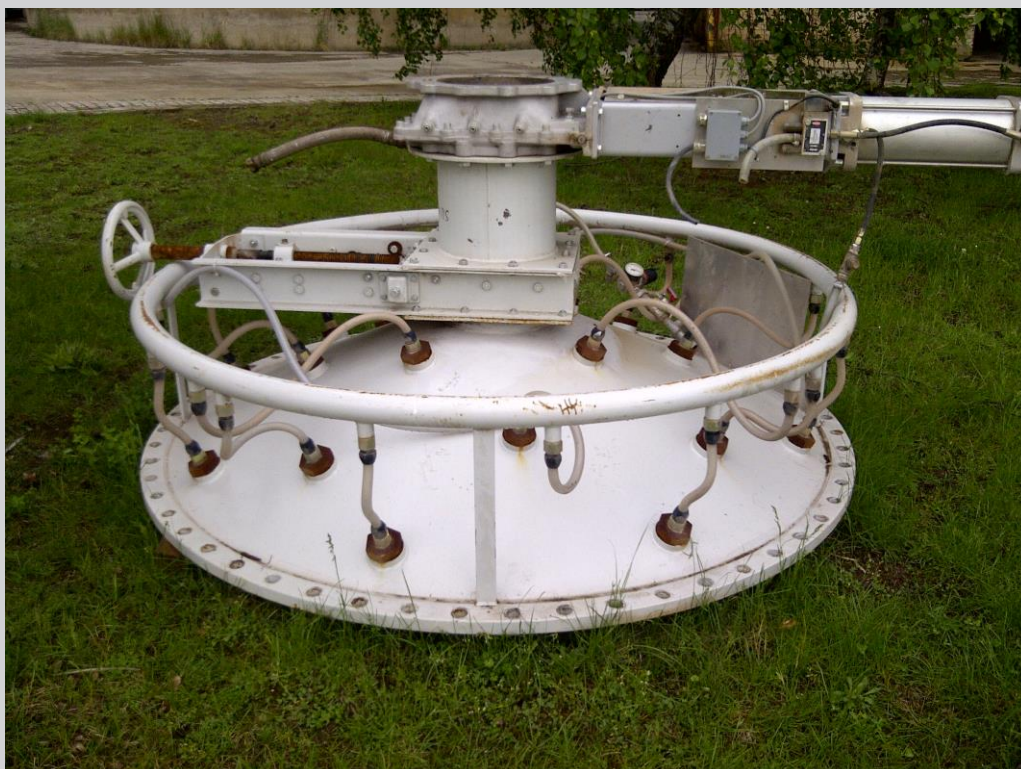
Siloboden mit Belüftung zur Materialauflockerung sowie mechanischem Flachschieber zur Wartung und pneumatischen Absperrschieber
