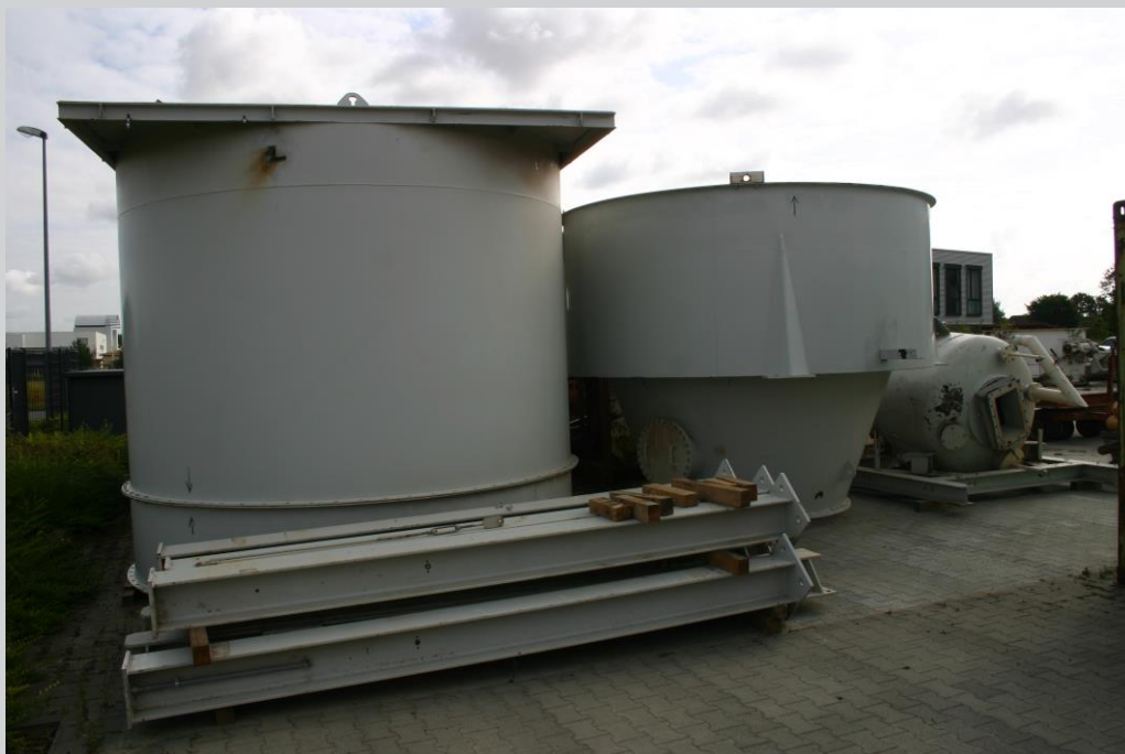
Silozylinder, Siloaustragskonus und Stahlfüsse
