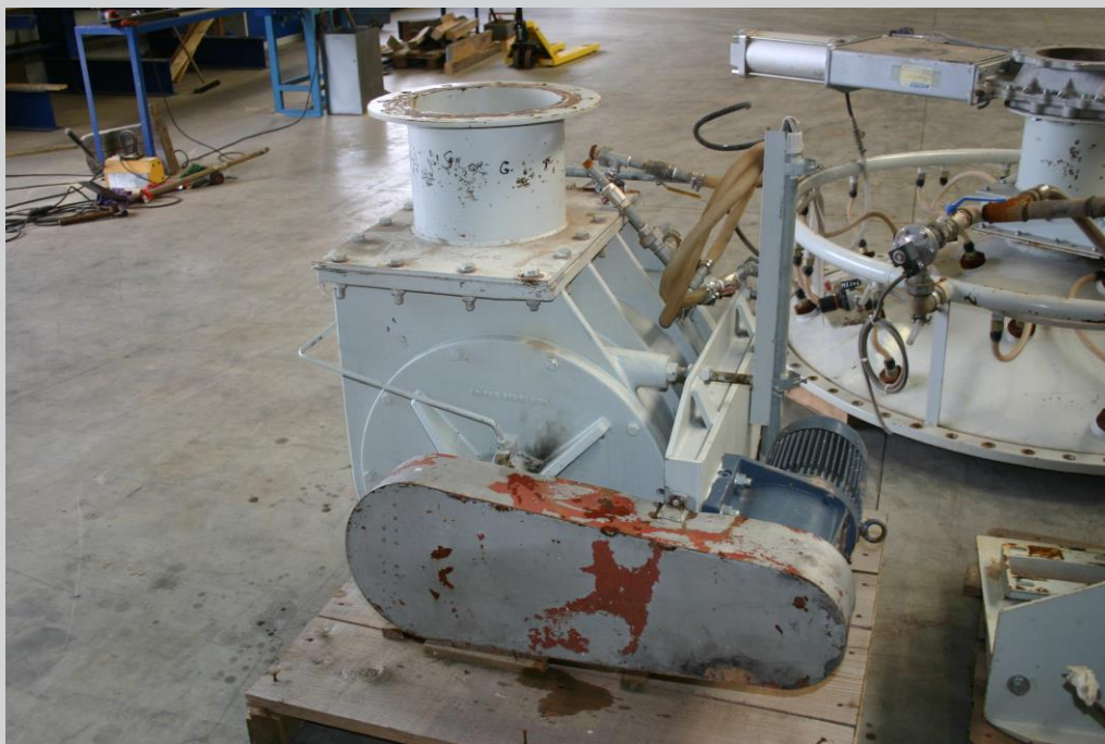
Zellenradschleuse zur Befüllung der Dosiereinrichtung
