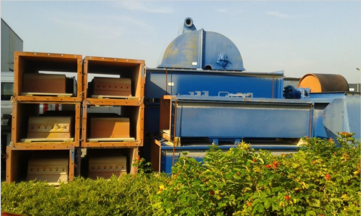
Bild 1: Gurtbecherwerk 630 mm x 23m
